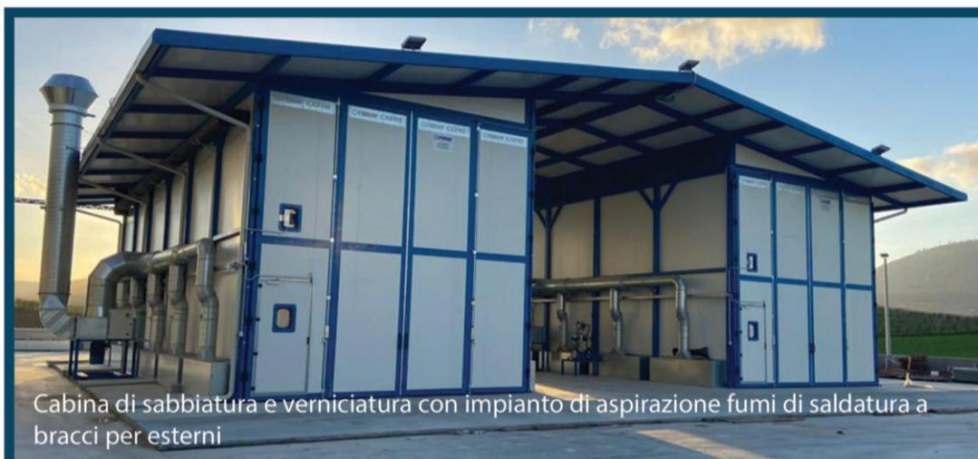
Cabina di sabbiatura e verniciatura con impianto di aspirazione fumi di saldatura a bracci per esterni
